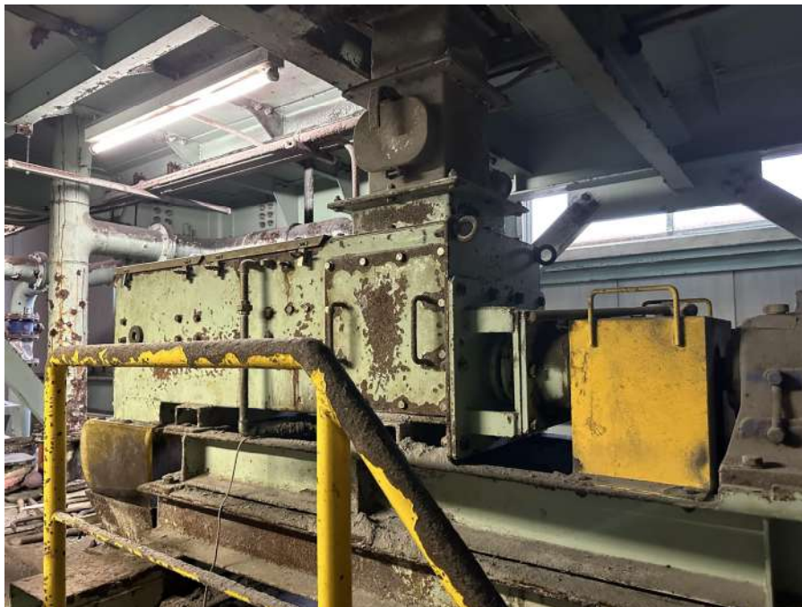
ごみ焼却施設 溶融飛灰混錬機（ようゆうひばいこんれんき）
